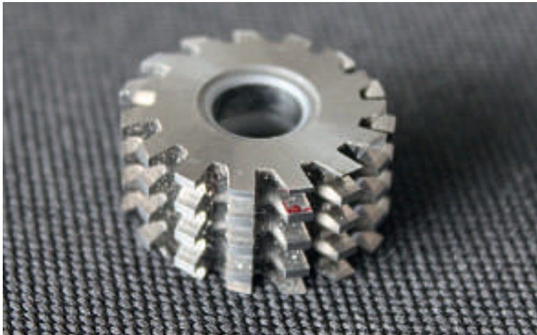
Komplexe Konturen wie bei diesem Abwälzfräser sind für die neue Profilschleifmaschine kein Problem, da sie jeden Zahn einzeln und vollautomatisch schleifen kann. (Bilder: Fanuc)
